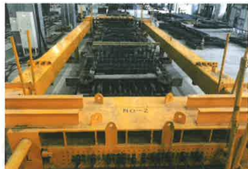
写真 - 4 簡易緊張装置（1 基）
